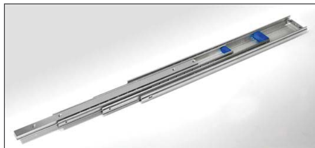
Guida telescopica a quattro elementi per corse pari a una volta e mezza la lunghezza della guida chiusa.
